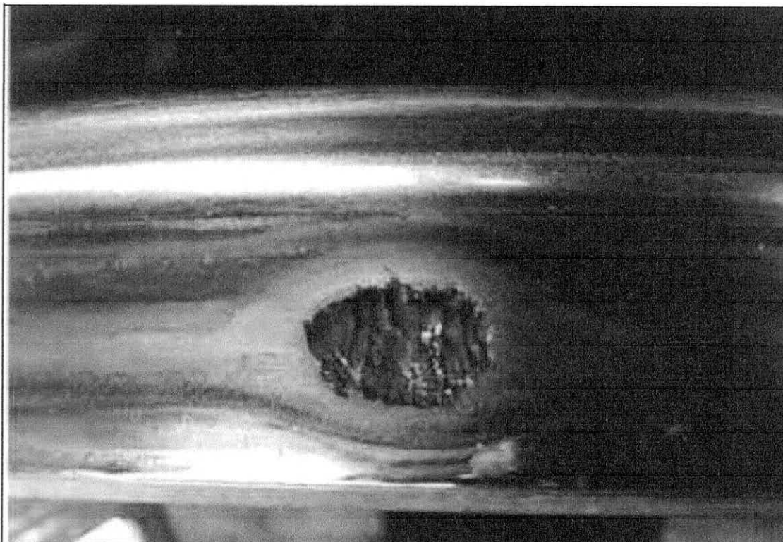
Figura 4. Defeito do tipo shelling na pista de rolamento de uma roda ferroviária. Fonte: [1].
